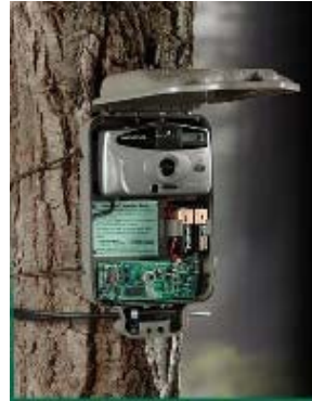
Figura 2: Trampa cámara DeerCam DC-100.
