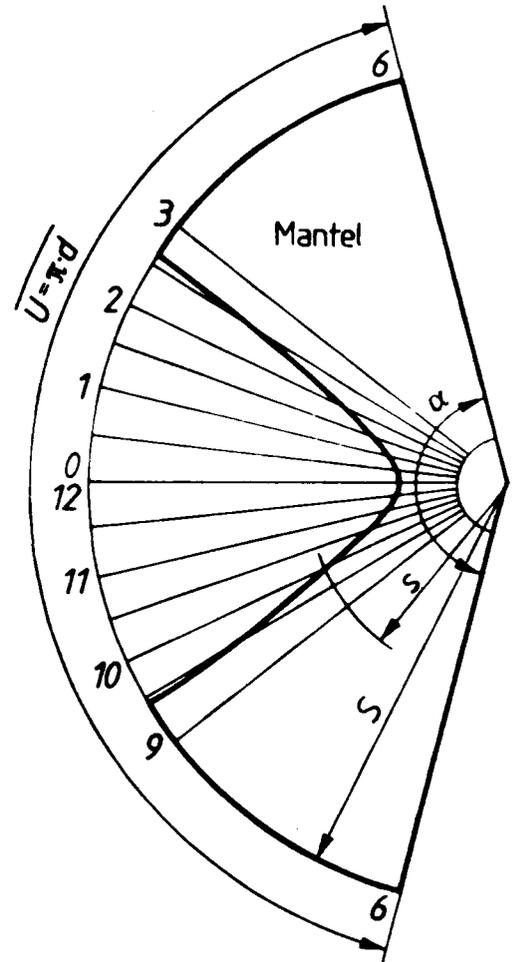
Konstruktion der Hyperbel und der Abwicklung durch Mantellinien
