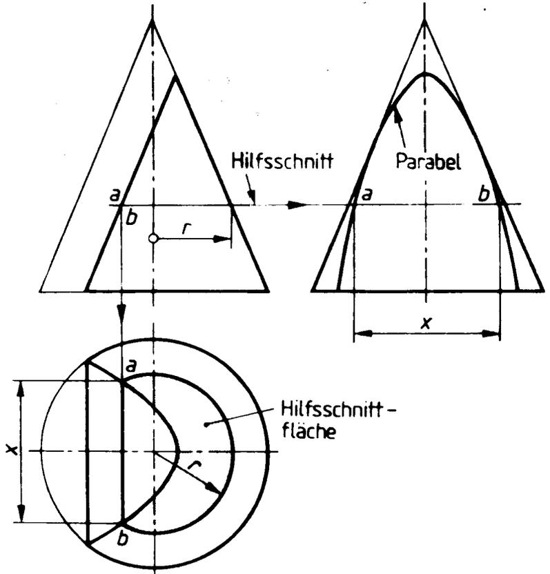
Konstruktion der Parabel durch Hilfsschnitte
