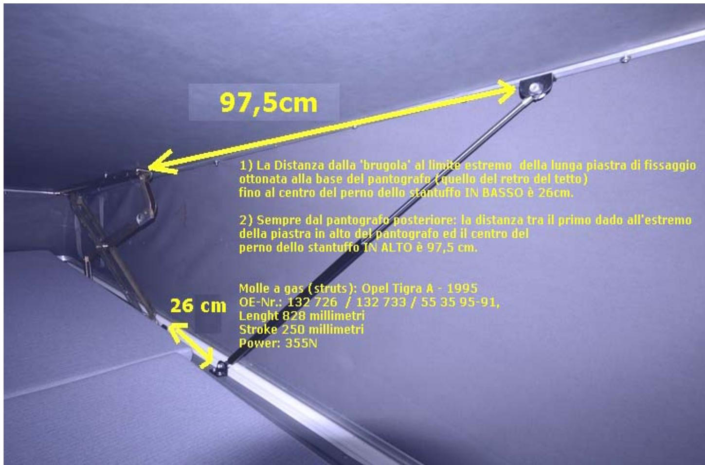
Calcolare il punto in cui fissare la **staffa di base** valutando anche l'estensione dello stantuffo a tetto chiuso (aiuta smontare il pannello del Letto superiore). Nel nostro caso la molla a gas Opel Tigra CHIUSA dal centro perno inferiore a centro perno superiore è 50cm.
