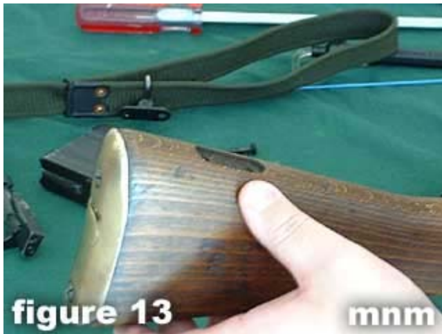
13) Remove the rear swivel .
