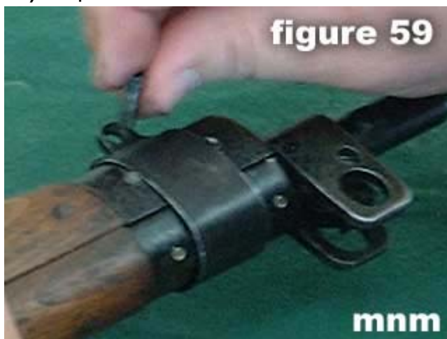
59) Replace the upper band screw .
