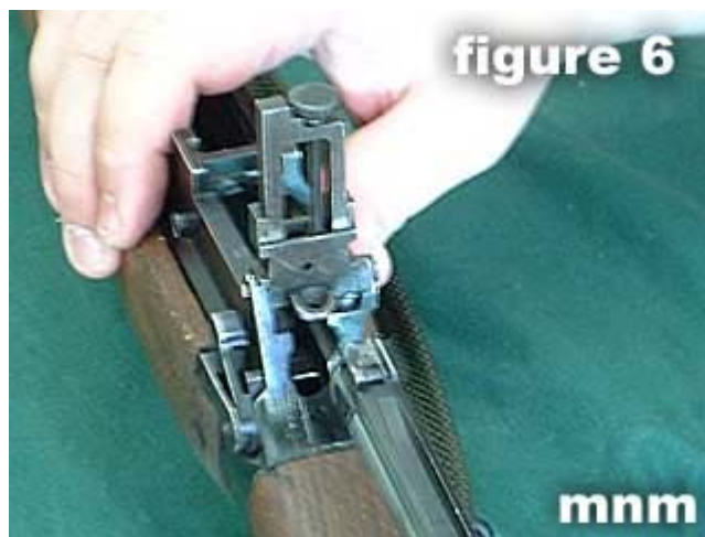
6) Remove the bolt .
