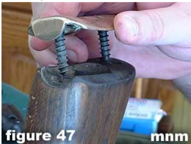
47) Install the buttplate.
