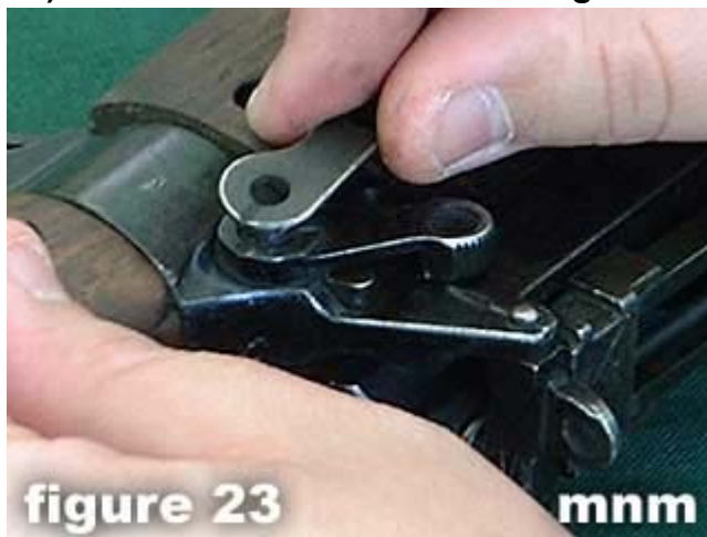
23) Remove the locking bolt spring .
