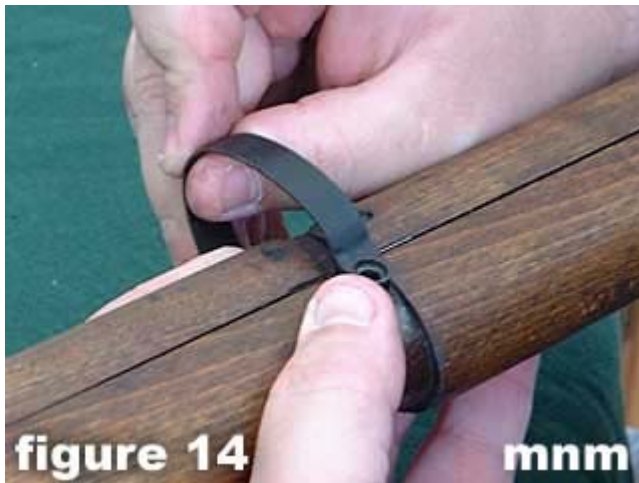
14) Remove the swivel band .
