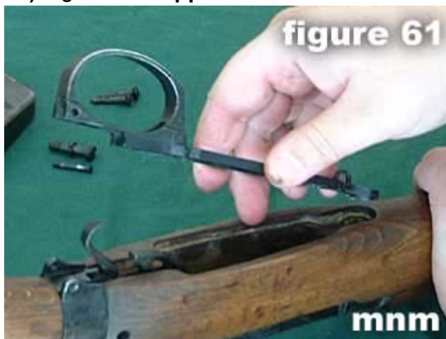
61) Replace trigger guard .
