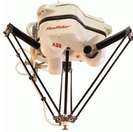
Figura 1.2: Robot Manipulador Paralelo tipo DELTA
