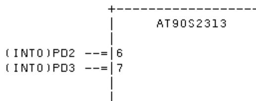
ขาสำหรับกรอินเตอร์รัพท์จากภายนอก จะเป็นขาเดียวกับ PD2 และ PD3
