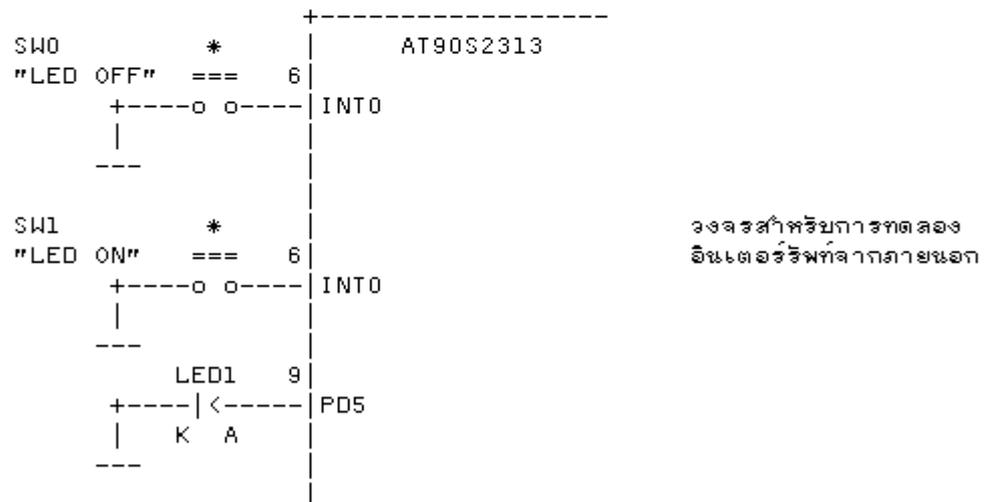
จะทำให้เกิดการอินเตอร์รัพท์ที่ขอบขาของ ในสภาวะปกติถ้าเราไม่กดสวิตช์ SW0 ลอจิกที่ขา INTO จะเป็นลอจิก 1 ถ้ากดสวิตช์ SW0 ขา INTO จะเปลี่ยนเป็นลอจิก 0 ช่วงขอบขาของพินส์ที่ขา INTO จะทำให้ external interrupt เริ่มทำงาน ขา INT1 ก็ทำงานในลักษณะเดียวกัน
